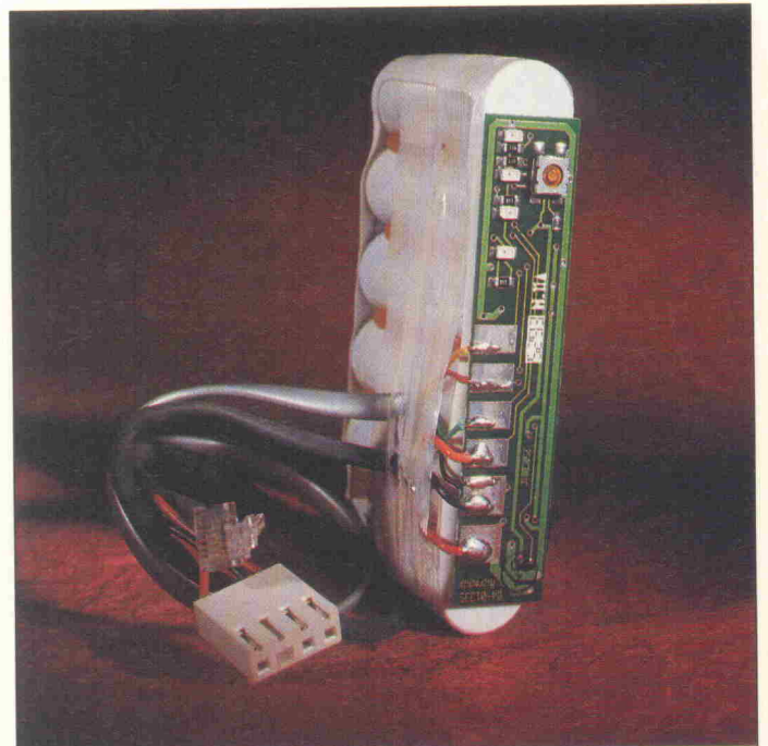
Bild 14. Die SMD-Platine kann so klein aufgebaut werden, daß sie in Konfektionierungen aus Mignon-Zellen hineinpaßt.
